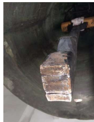
Alte Klöppel mit angeschweißtem Stahl; Fotos: Daniel Orth
